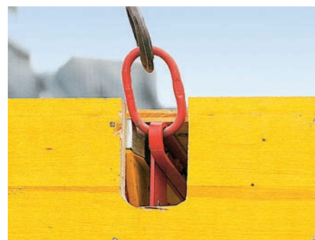
Attacco di sollevamento 24 dx/sx Portata massima 700 kg, con un angolo di inclinazione delle funi della braca rispetto alla verticale di max. 15°.
