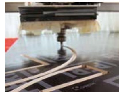
I pannelli di rivestimento sono prodotti su misura con impianti CNC.
