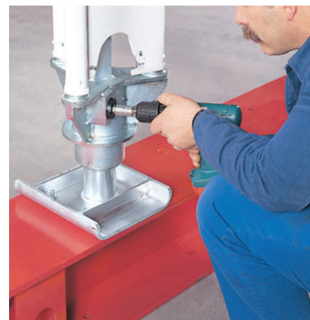
Per abbassare è sufficiente l'uso di un normale avvitatore/svitatore con chiave a bussola Ch 19 (non usare il trapano a percussione).
