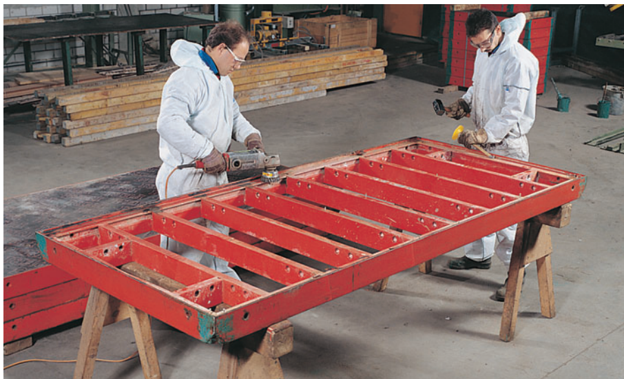
Asportazione dei rivetti e pulizia del telaio
