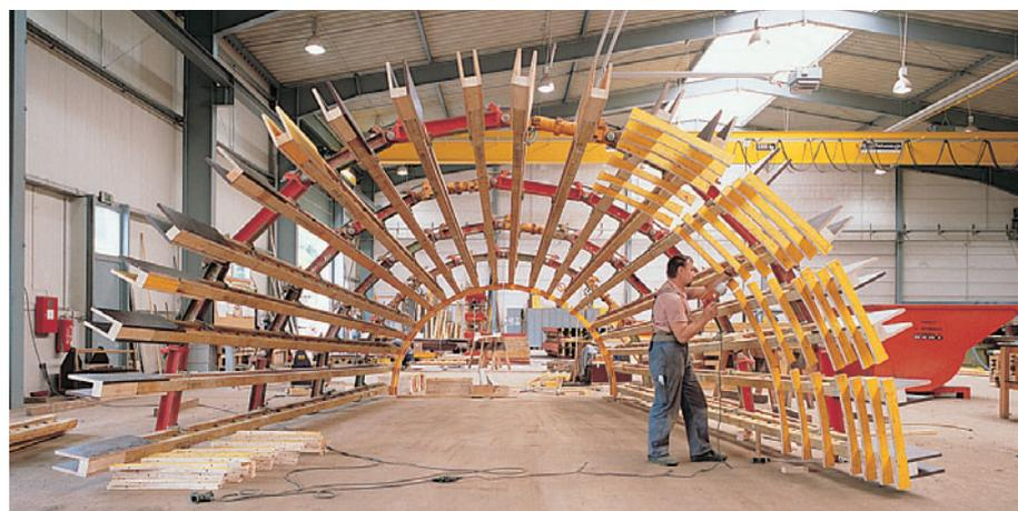
Per consentire una messa in opera corretta, l'intera cassaforma per ponti ad arco viene pre-assemblata e poi trasportata in cantiere divisa in più segmenti.
