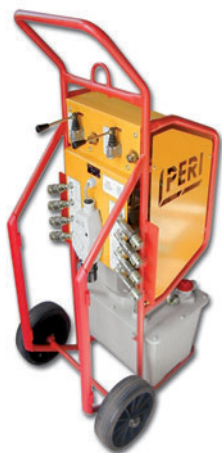
La centralina idraulica RCS consente di ridurre la dotazione di attrezzature e costi.
