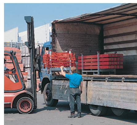
Le barelle RP si possono movimentare facilmente anche con il carrello elevatore.
