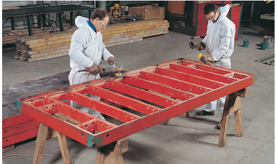
Asportazione dei rivetti e pulizia del telaio
